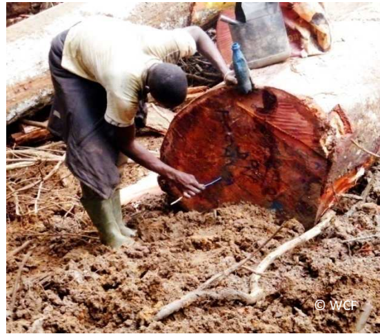
Figure 8 : marquage d'une bille sur le parc à bois
